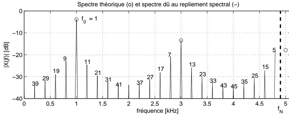
FIG. 1: Repliement spectral pour un signal carré
