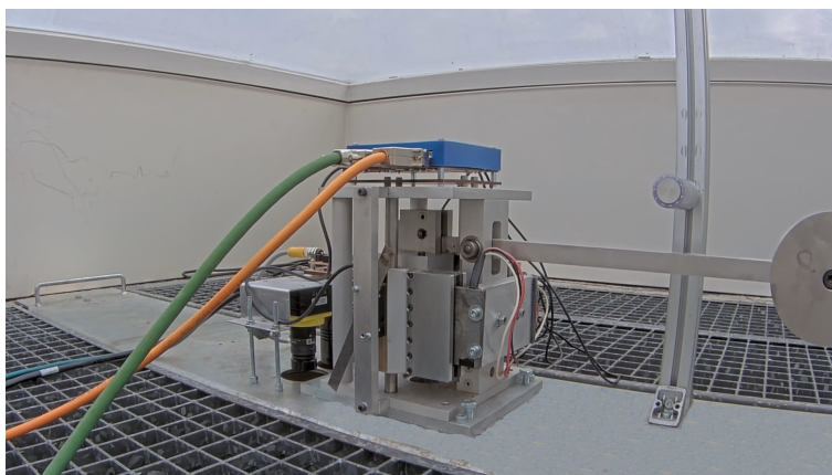
FIG. 16 : Plateforme de suspension et commande du pendule
